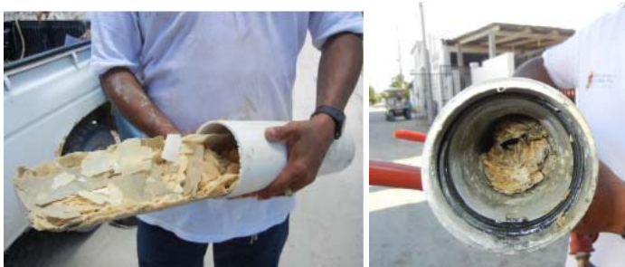
Fig.4.1 Tuberías obstruidas por sarro acumulado.
