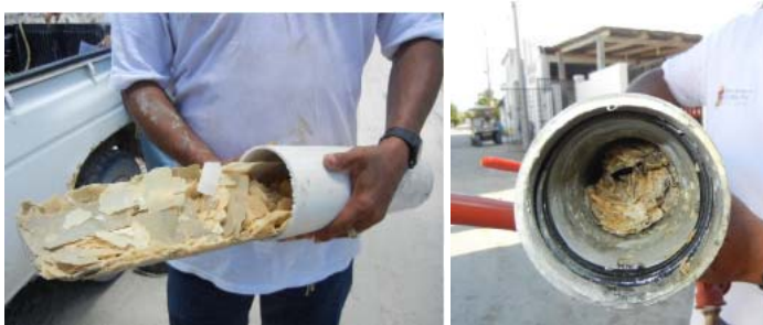
Fig.4.1 Tuberías obstruidas por sarro acumulado.
