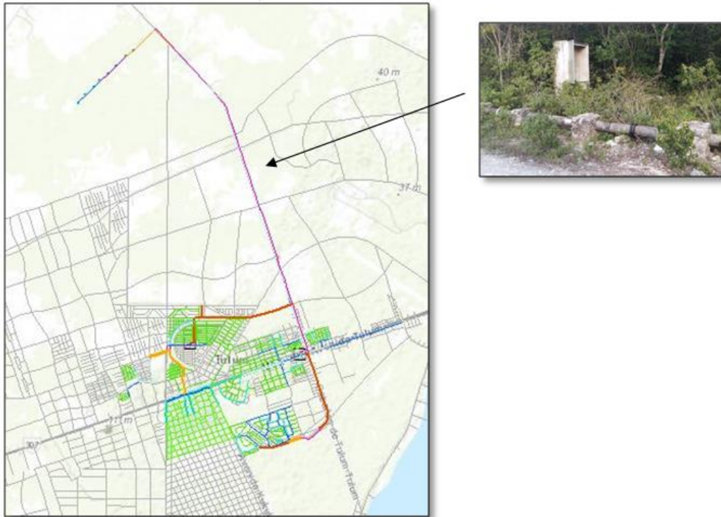
Fig. 5.3 Línea de conducción de 8" desde la zona de captación a la ciudad de Tulum.
