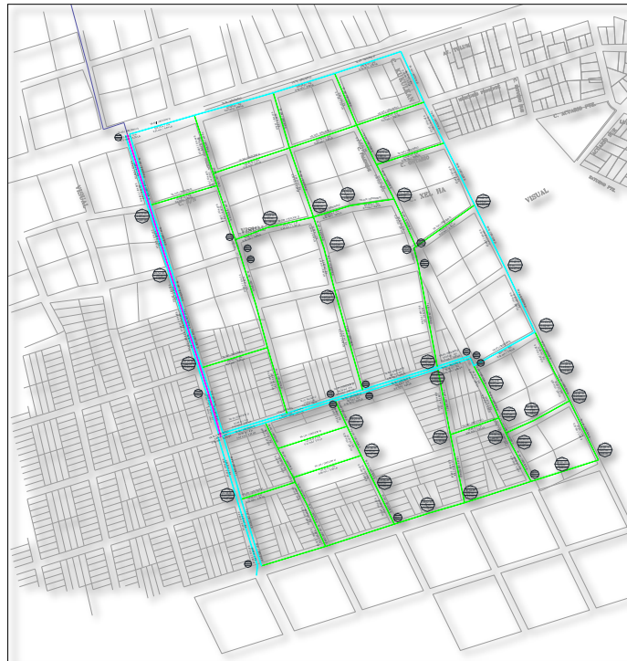
Fig. 7.5 Segunda sección de la red de agua potable en la Colonia La Veleta.
