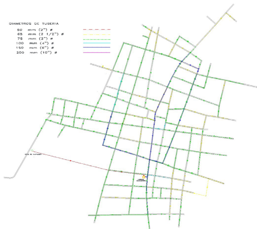
Figura 4.- Líneas Primarias de Agua Potable en la localidad de CHUNHUHUB.
