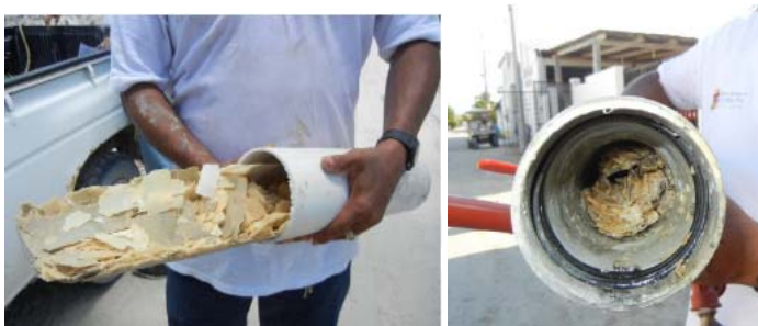
Fig.4.1 Tuberías obstruidas por sarro acumulado.
