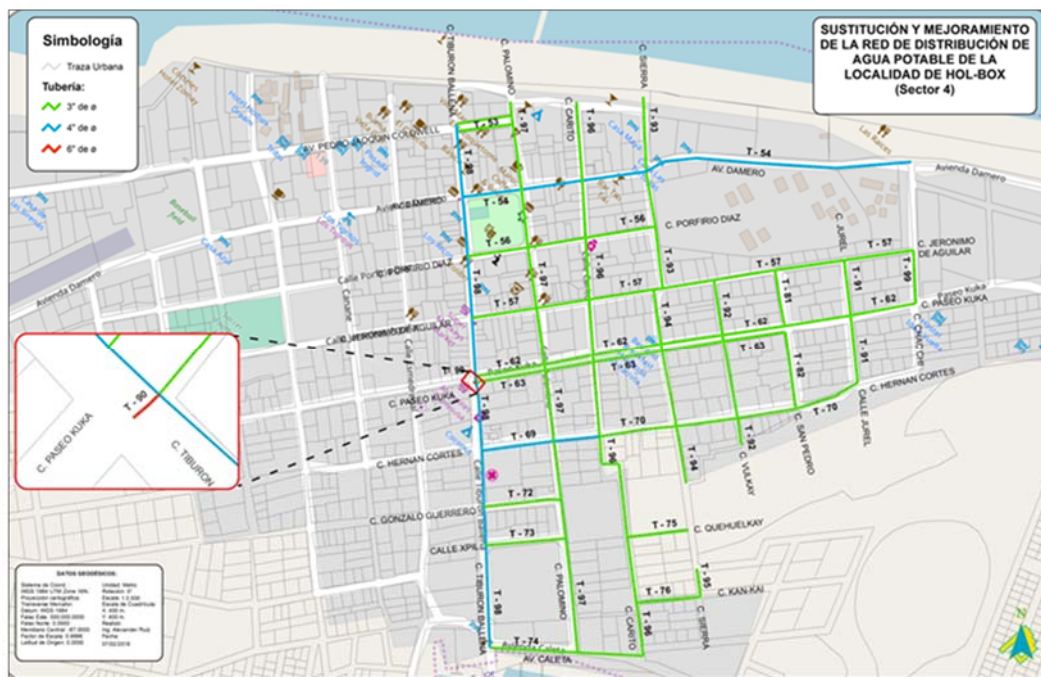
Fig. 7.1 Línea de conducción y red de distribución del sector 4.
