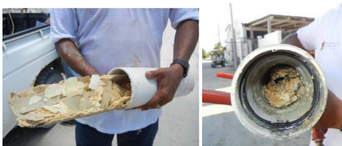
Fig.4.1 Tuberías obstruidas por sarro acumulado.
